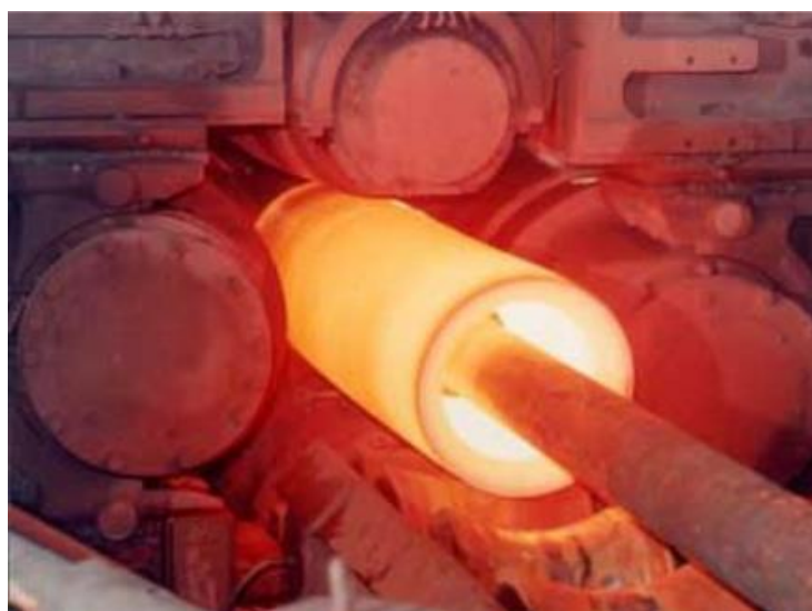
Figura 2.3 – Etapa do processo de Mannesmann (Moro et al., 2007)
