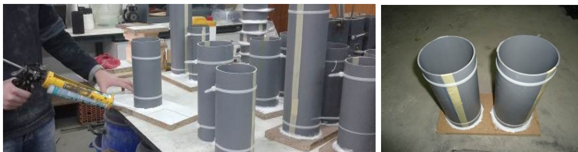
Figura 3.5 – Tubos PVC para fabrico dos provetes cilíndricos
