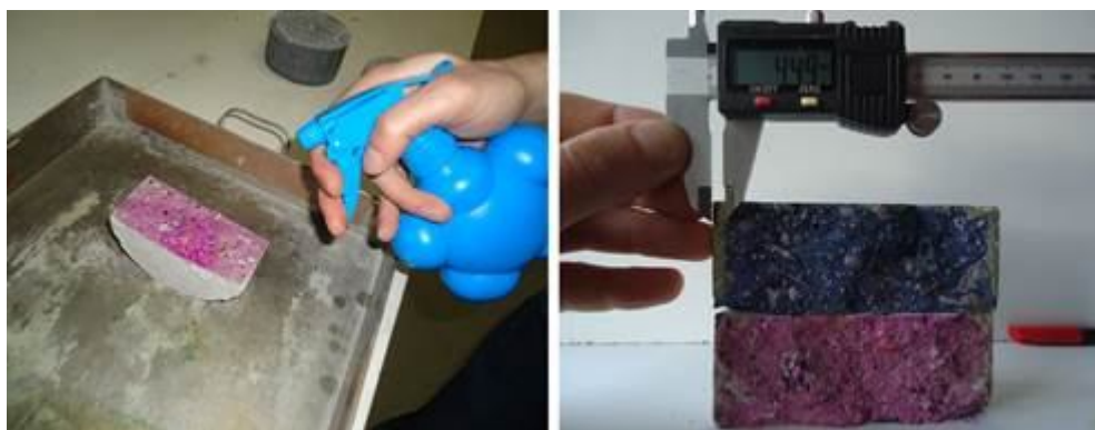
Figura 4.8 – Pulverização do provete e leitura da profundidade de carbonatação
