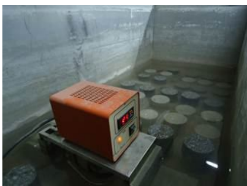
Figura 3.7 – Cura das amostras em tanque com condições de temperatura pretendidas
