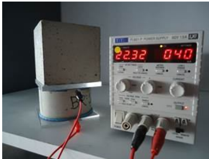
Figura 3.14 – Medição da resistividade elétrica de um dos provetes de BN aos 14 dias
