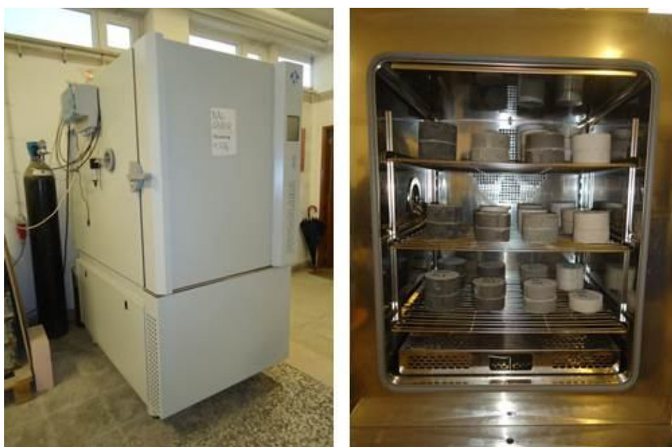
Figura 3.11 – Câmara de carbonatação acelerada FITOCLIMA 300
