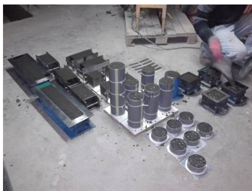
Figura 3.6 – Betonagem dos provetes
