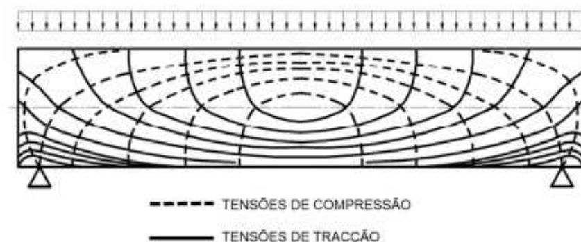
Figura 2.2 – Linhas isostáticas de um material elástico linear homogéneo, adaptado de Camacho (2003).
