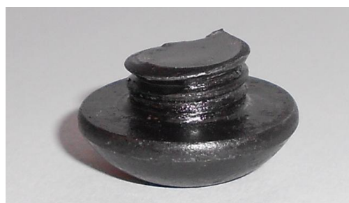
b) Modo de rotura dos parafusos
