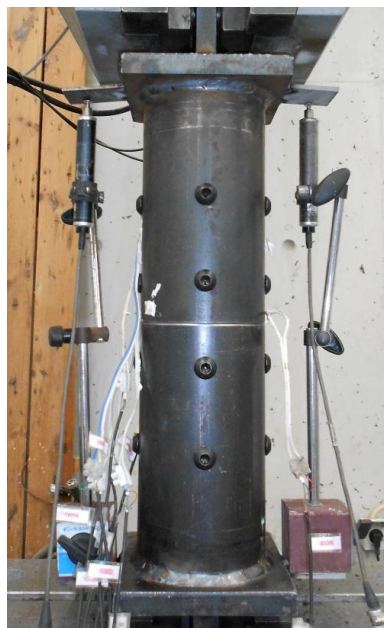
Figura 4.15 – Posição dos transdutores de deslocamento
