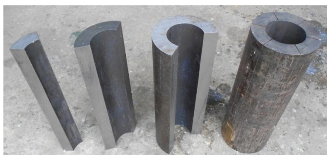
a) Processo de seccionamento do tubo interior
