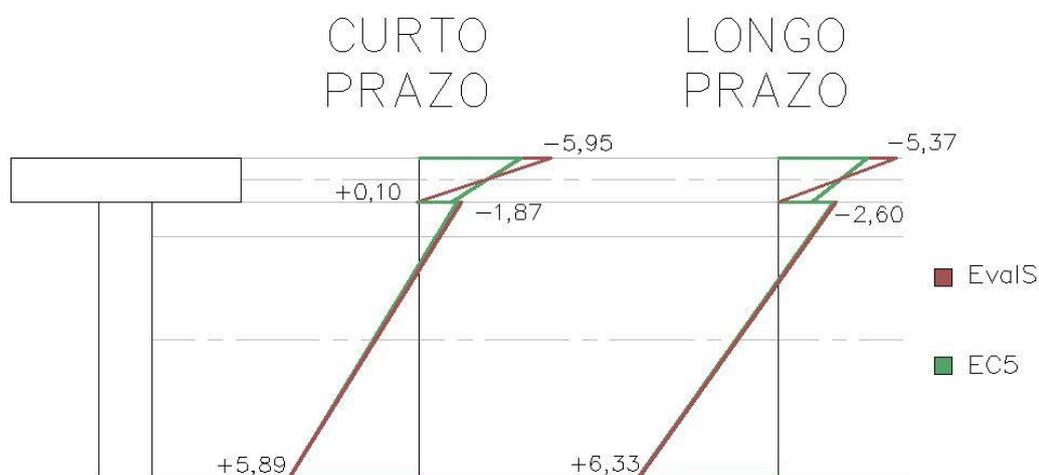
Figura 5.1 - Tensões na secção mista para Estados Limites Últimos a curto e longo prazo, com os valores das tensões em  $\text{N/mm}^2$
