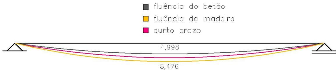
Figura 5.6 - Deslocamentos a meio vão provocadas pelas ações estáticas tendo em conta os efeitos da fluência do betão e da madeira, com os valores dos deslocamentos em mm
