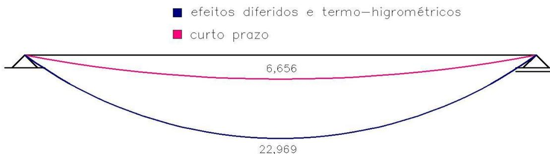
Figura 5.10 - Deslocamentos a meio vão numa análise a curto prazo considerando apenas as ações estáticas e numa análise a longo prazo considerando as ações estáticas e cinemáticas, com os valores dos deslocamentos em mm
