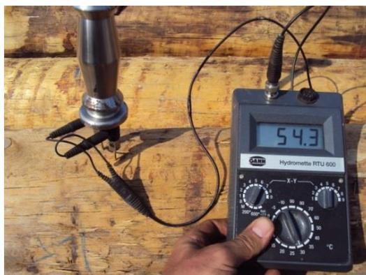
Figura 4.7 - Equipamento de medição do teor de água
