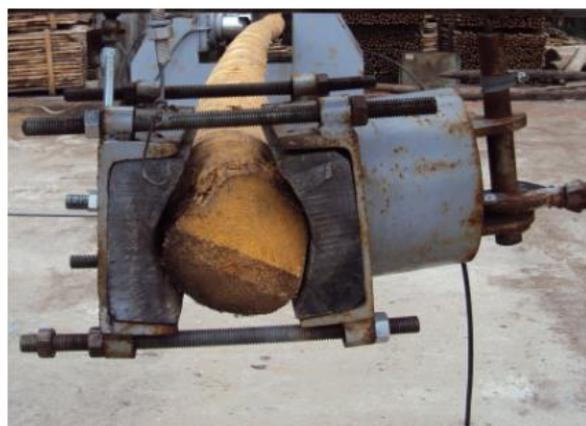
Figura 4.2 – Zona de aplicação da carga
