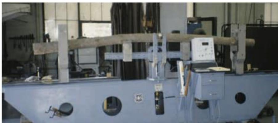
Figura 2.5 – Ensaio de flexão estática utilizando o *Metiguard model 312* (Wang X. *et al.*, 2001)
