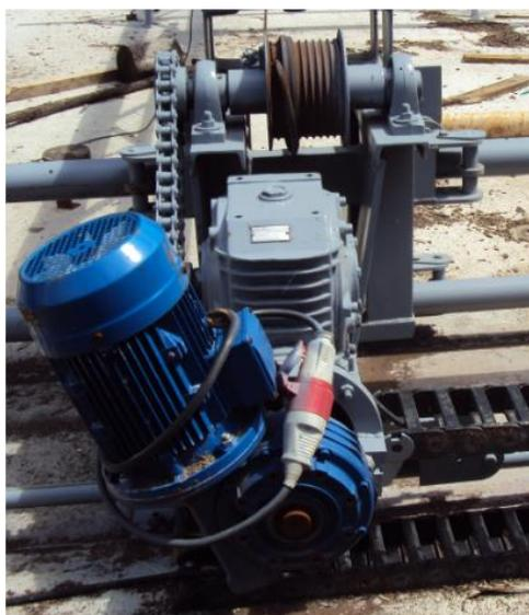
Figura 4.4 – Motor com um cabo de aço ligado a uma célula de carga
