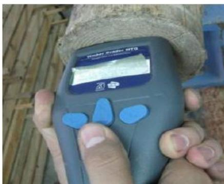
Figura 2.1 - Aparelho *Timber Grander MTG* (Morgado, 2012)
