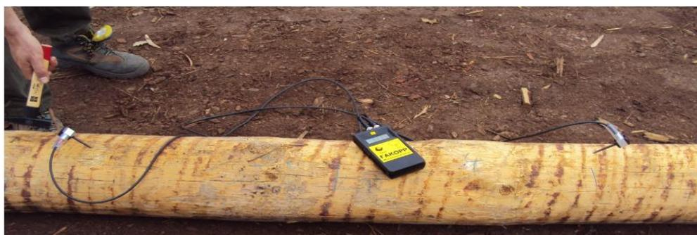
Figura 3.13 – Esquema de ensaio de ultra-sons
