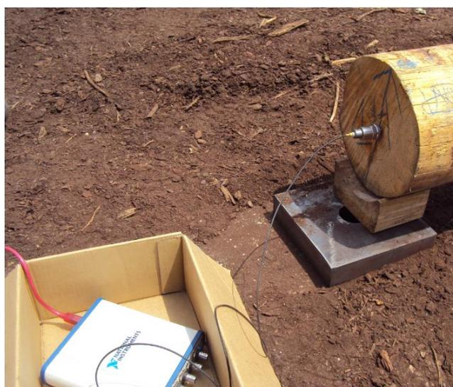
Figura 3.12 – Posicionamento do acelerómetro no ensaio de vibração longitudinal
