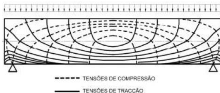
Figura 2.2 – Linhas isostáticas de um material elástico linear homogéneo
