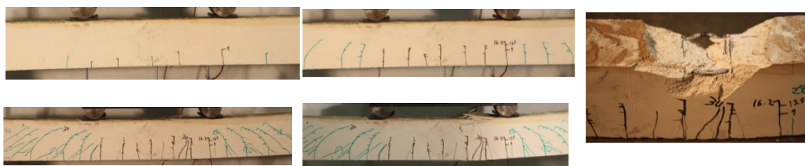
Figura 4.55 – Evolução das fendas na Viga META-4F8 para cargas de 9\text{kN} , 16\text{kN} , 44\text{kN} e 35\text{kN} , e posição das fendas.
