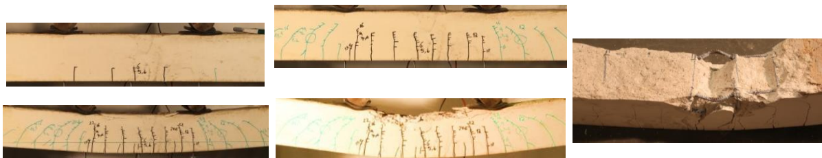
Figura 4.40 – Evolução das fendas na Viga META-3F6 para cargas de 6kN, 16kN, 26kN e 19kN, e pormenor da posição de fendas.
