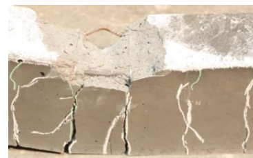
Figura 4.61 – Viga CIN-4F6 durante o ensaio e pormenor da rotura.
