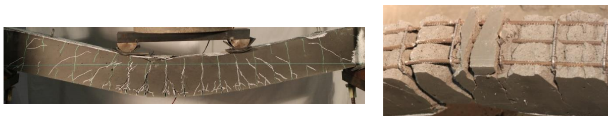
Figura 4.59 – Viga CIN-3F6 durante o ensaio e pormenor da rotura.
