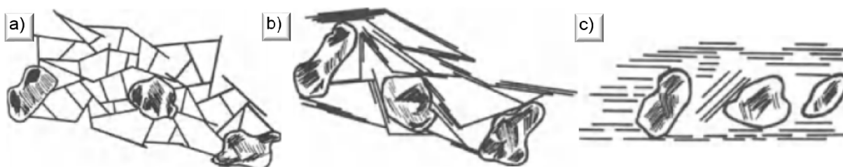
Figura 2.2 – Diagramas de disposição das partículas de argila: a) ambiente marinho; b) ambiente de água doce; c) estado reconstituído (Bennett e Hulbert, 1986)
