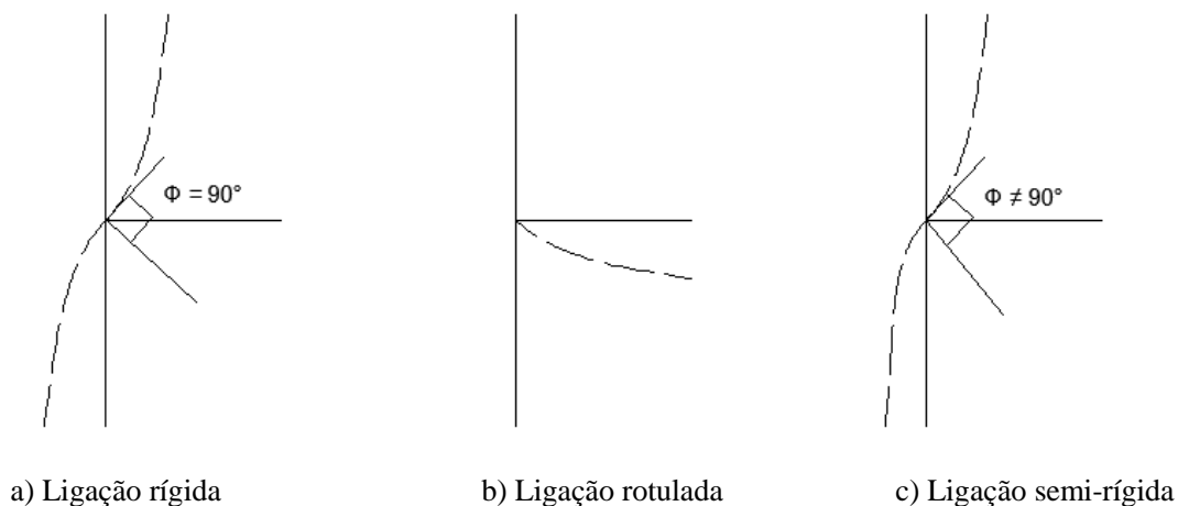
Figura 2.1 – Representação esquemática da deformação existente entre uma viga e um pilar em função da rigidez da ligação
