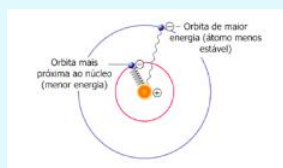
Figura 17: Demonstração do comportamento do elétron quando o átomo é excitado Fonte: http://www.ebah.com.br/content/ABAA7YgAL/quimiluminescencia-bioluminescencia .
