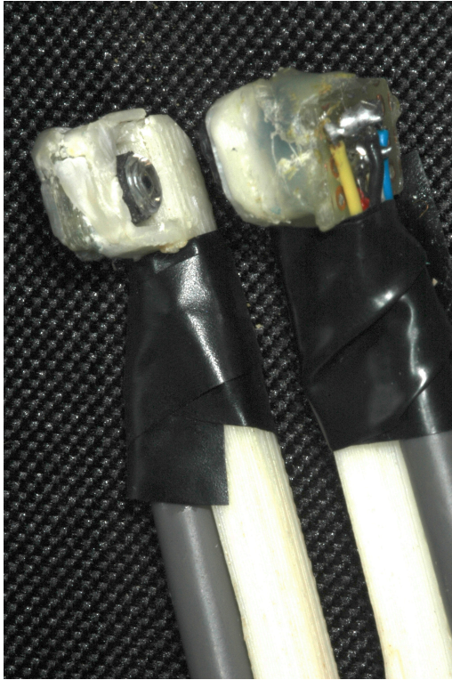
Figura 2. Componente emissora e componente receptora do sensor.
