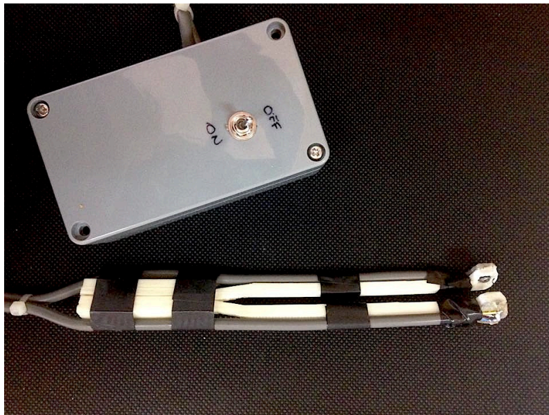
Figura 1. Constituição do sensor: Componente electrónica ligada por fios à componente emissora e receptora.
