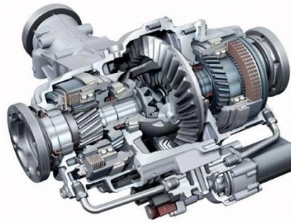
**Figura 2.11.** Diferencial de um automóvel moderno (fourtitude, 2016).
