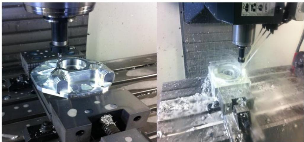
**Figura 3.4.** Fabrico do componente em estudo através do processo de maquinação (ExtraMotion, 2016).
