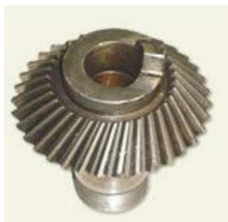
**Figura 2.17.** Engrenagem cónica helicoidal (Marat-Mendes, 2012).
