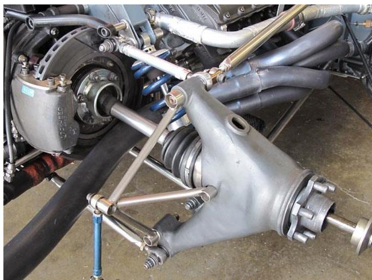
**Figura 2.22.** Sistema de travagem *inboard* (Cook's, 2016).
