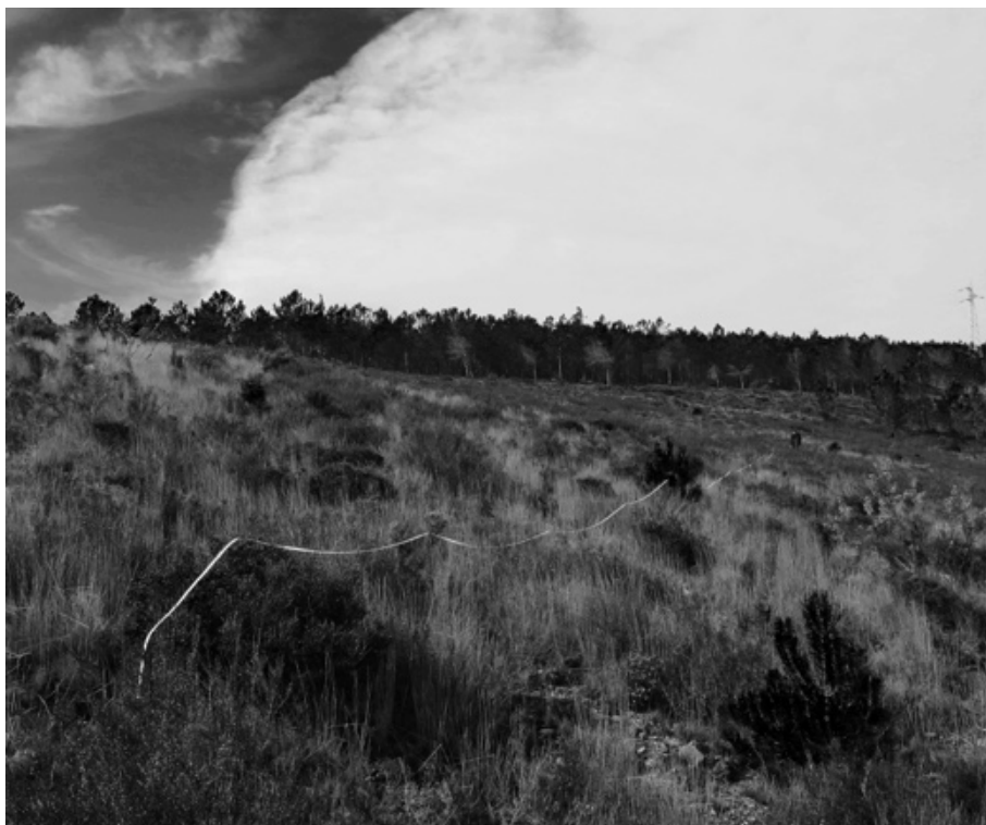
Figura 3.1. Disposição de linha transecto em parcela para realização ensaio campo seguindo MLI
