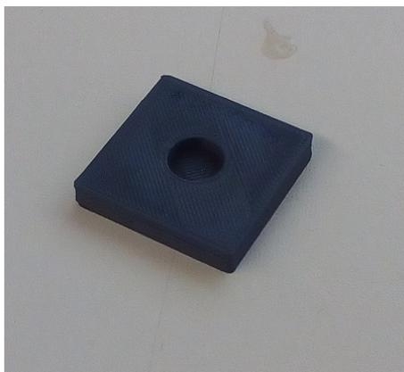
**Figura 3.4:** Molde destinado à conformação dos discos de gelo seco.
