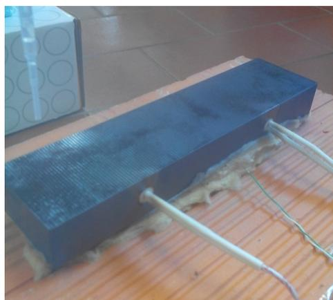
**Figura 3.7:** Calha dentada de cobre, com as resistências de aquecimento colocadas no seu interior.
