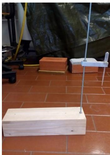
**Figura 3.5:** Conjunto utilizado para a colocação das gotas de água.
