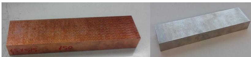
**Figura 3.1:** À esquerda, uma das peças de cobre utilizadas. Na figura da direita, peça de alumínio. As superfícies dentadas foram maquinadas a partir de blocos de dimensão inicial  $200 \times 50 \times 25$  [mm].
