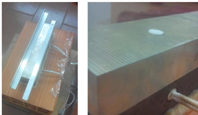
**Figura 3.9:** Barreiras utilizadas no controlo do movimento do disco, na figura da esquerda. À direita, disco de gelo sobre uma das texturas dentadas em teste.
