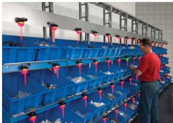
Figura 2.2. Exemplo do processo " pick to light " (Rogers, 2011)
