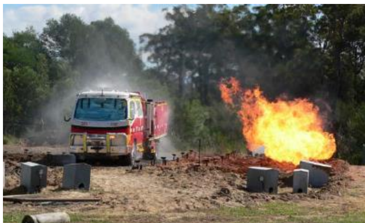
Figura 3.2 - Sistema de aspersores ativos numa simulação de frente. Foto : CSIRO
