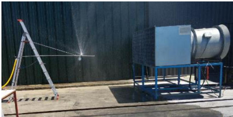
Figura 4.7 - Disposição dos materiais nos testes com vento
