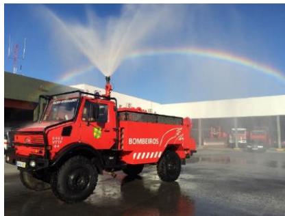
Figura 3.4 - Canhões montados no veículo. Foto: CEIF/ADAI
