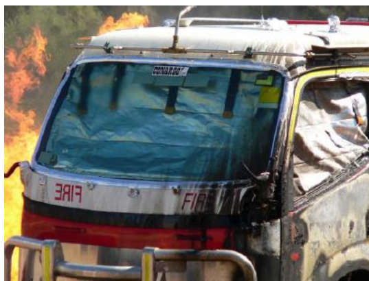
Figura 3.3 - Manta de proteção. Foto : CSIRO
