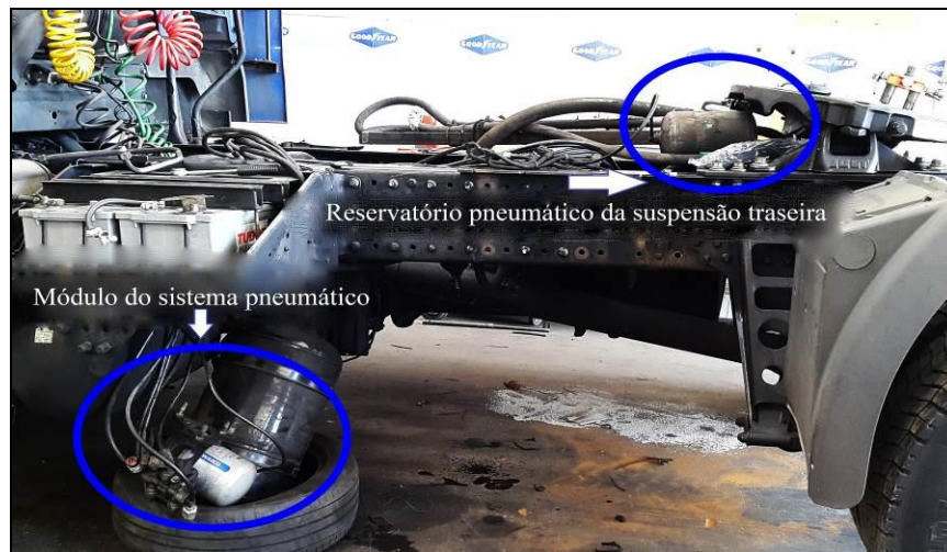
Figura 3.11- Componentes do sistema pneumático a relocar.
