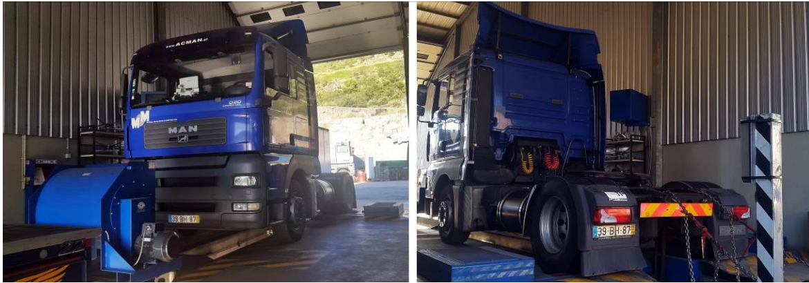
Figura 4.1- Testes em banco de potência.
