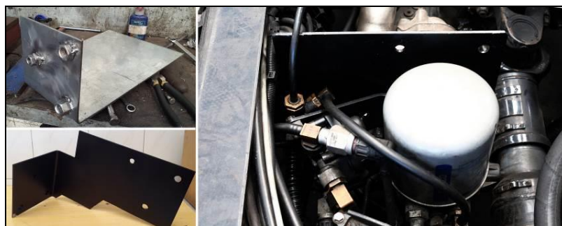
Figura 3.13- Suporte de fixação e módulo já relocado.
