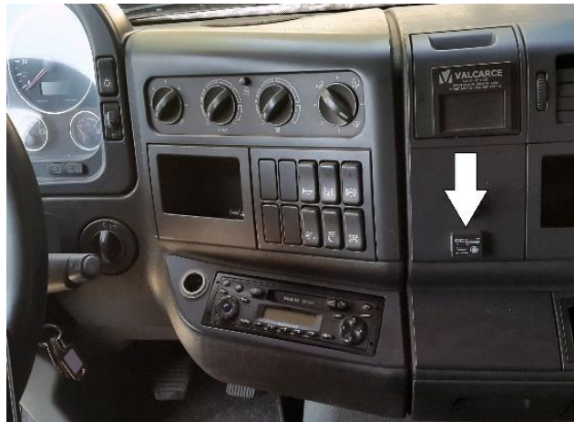
Figura 3.25- Comutador do sistema Dual-Fuel a GPL.
