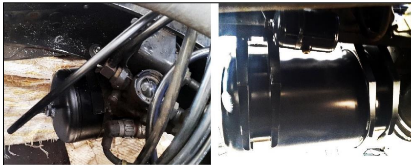
Figura 3.12- Reservatório pneumático relocado.
