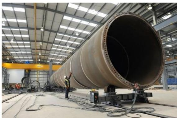
Figura 3.1. Viradores no processo de fabrico de torres eólicas (Williams, 2011)
