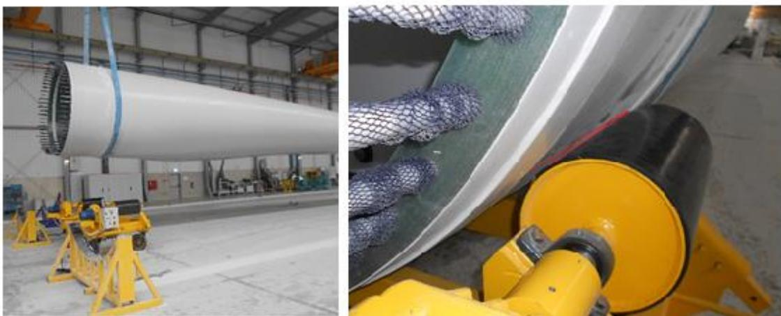
**Figura 3.11. Não conformidade no apoio pá/rolo**
