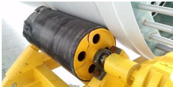
**Figura 3.12.**Estado da camada após ensaio
