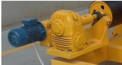
**Figura 4.13. Conjunto motor e redutor do equipamento**
