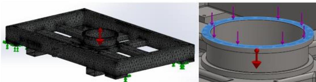
Figura 5.17. Malha usada no estudo e condições de fronteira
