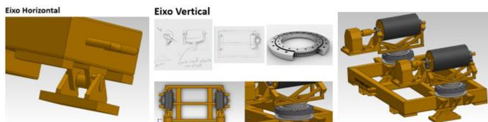
Figura 5.2. Primeiro conceito para a alteração da estrutura
