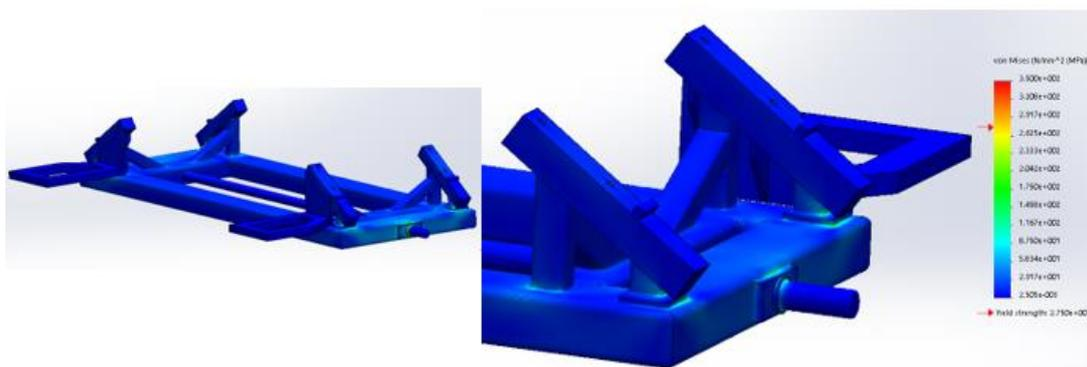
Figura 5.7. Tensões de von Mises
