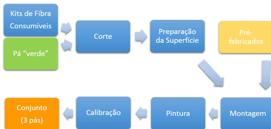
Figura 1.7. Operações realizadas no pavilhão de acabamentos
