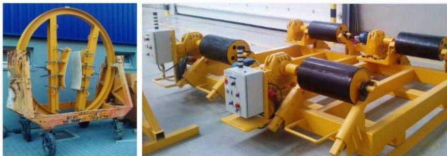
**Figura 3.10.** Apoio para a ponta da pá e vista oposta do apoio motriz
