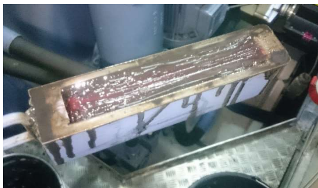
Figura 5.4. Massa antiga do rolamento com óleo “E” da Spanjaard
