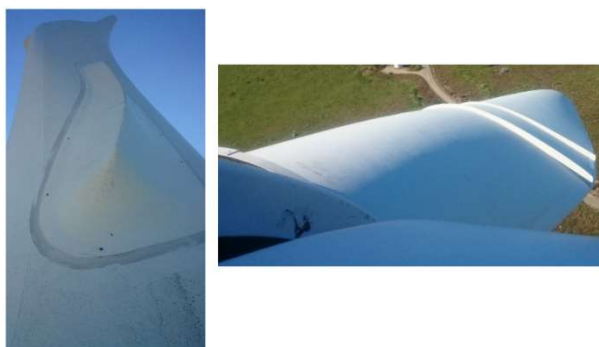
Figura 2.3. Incrementos aerodinâmicos das pás do rotor
