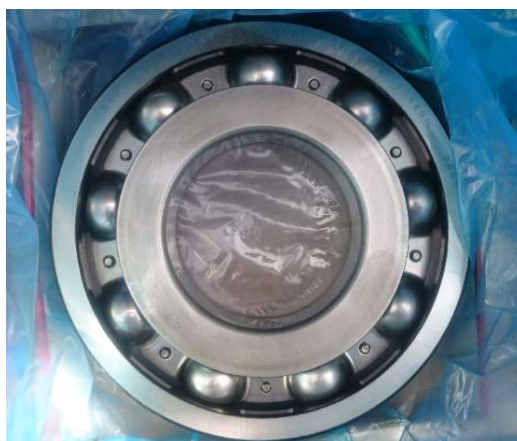
Figura 5.13. Rolamento SKF 6332/HC5C3S0VA970
