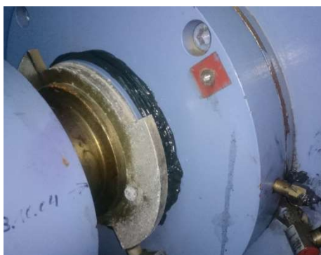
Figura 5.5. Mistura Spanjaard a sair pelo vedante
