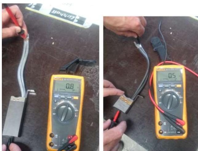
Figura 5.26. Medição da resistência elétrica das escovas com um multímetro
