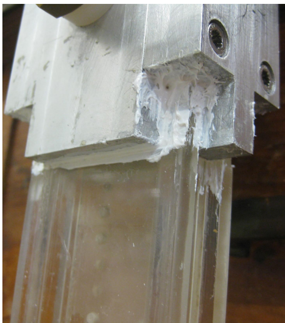
Figura Anexo A: .3: Fixação e vedação da peça de alumínio ao segmento de acrílico.
