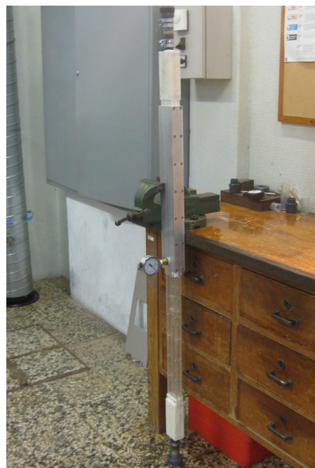
Figura Anexo A: .3: Fixação e vedação da peça de alumínio ao segmento de acrílico.
