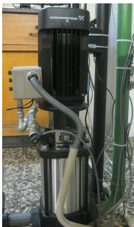
Figura 2.3: Bomba Grundfos CR5-8 e respetiva placa com as características.
