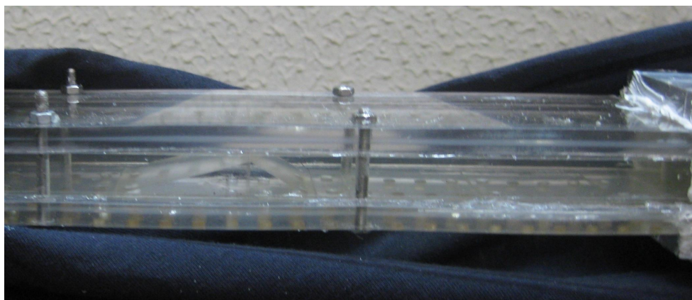
Figura 2.15: Disposição do pano escuro na secção de ensaios.
