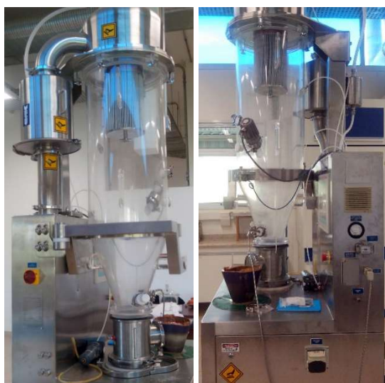
Figura 3.1. Fotografias do reator de leito fluidizado (instalado na UNICAMP).
