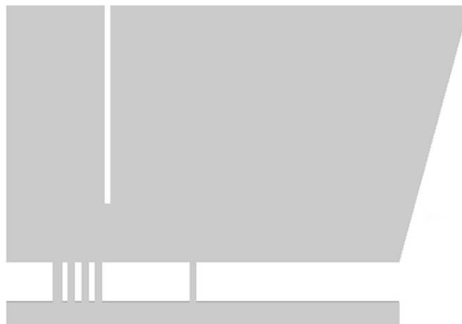
Figura 3.5. Representação adotada para os furos do distribuidor (bidimensional).
