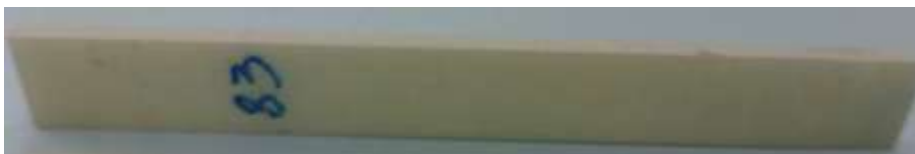
Figura 3.5. Provete obtido após maquinação com as dimensões recomendadas.
