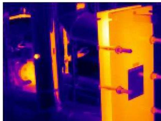
**Figura C.1** Imagem termográfica de permutador de calor sem isolamento térmico.
