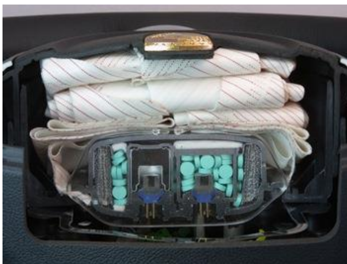
Figura 2.6 Interior de um módulo de airbag (Autoliv, 2015).
