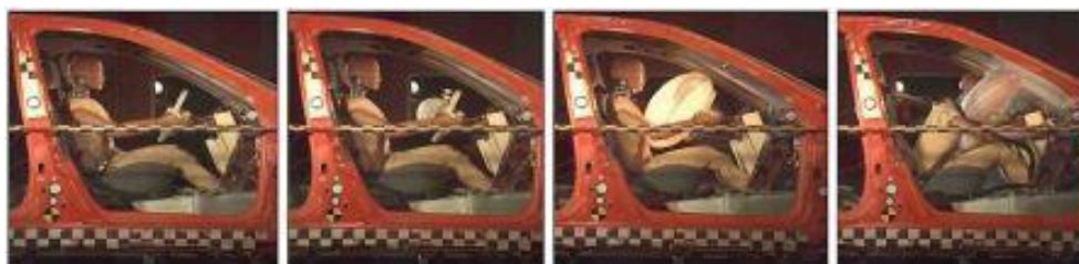
Figura 2.4 Decorrência de acontecimentos no disparo de um airbag (Autoliv, 2015).
