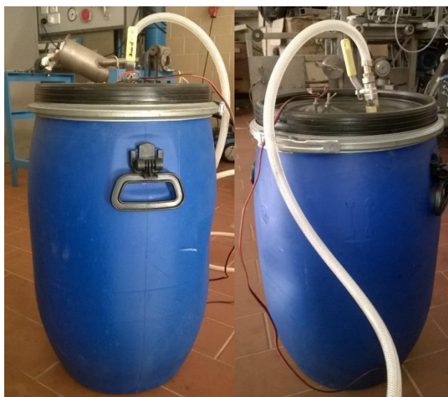
Figura 4.2 Ensaio experimental onde se efetuou os disparos dos geradores de gás.
