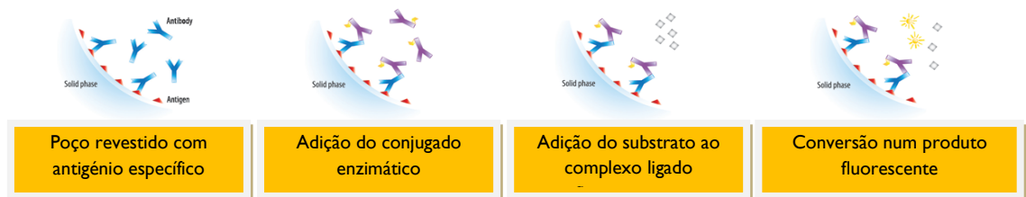
Ilustração 3 – Esquema representativo do Imunoensaio Fluoroenzimático realizado pelo Unicap 250. Fonte: www.phadia.com
