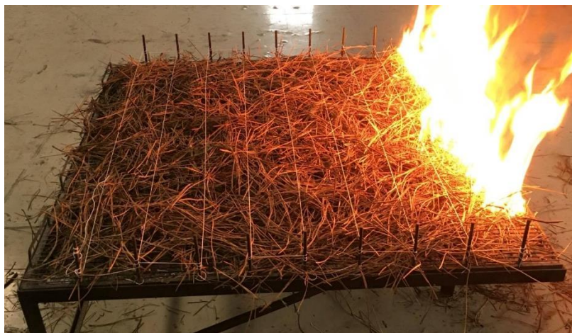
Figura 3.4. Mesa para a realização do ensaio de determinação do R_0 .
