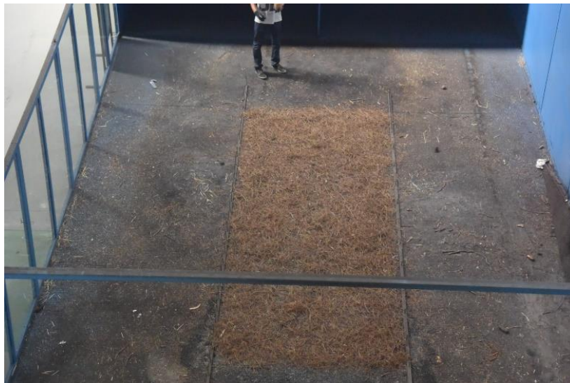
Figura 3.6. Leito retangular de caruma preparado para um ensaio no túnel de vento.
