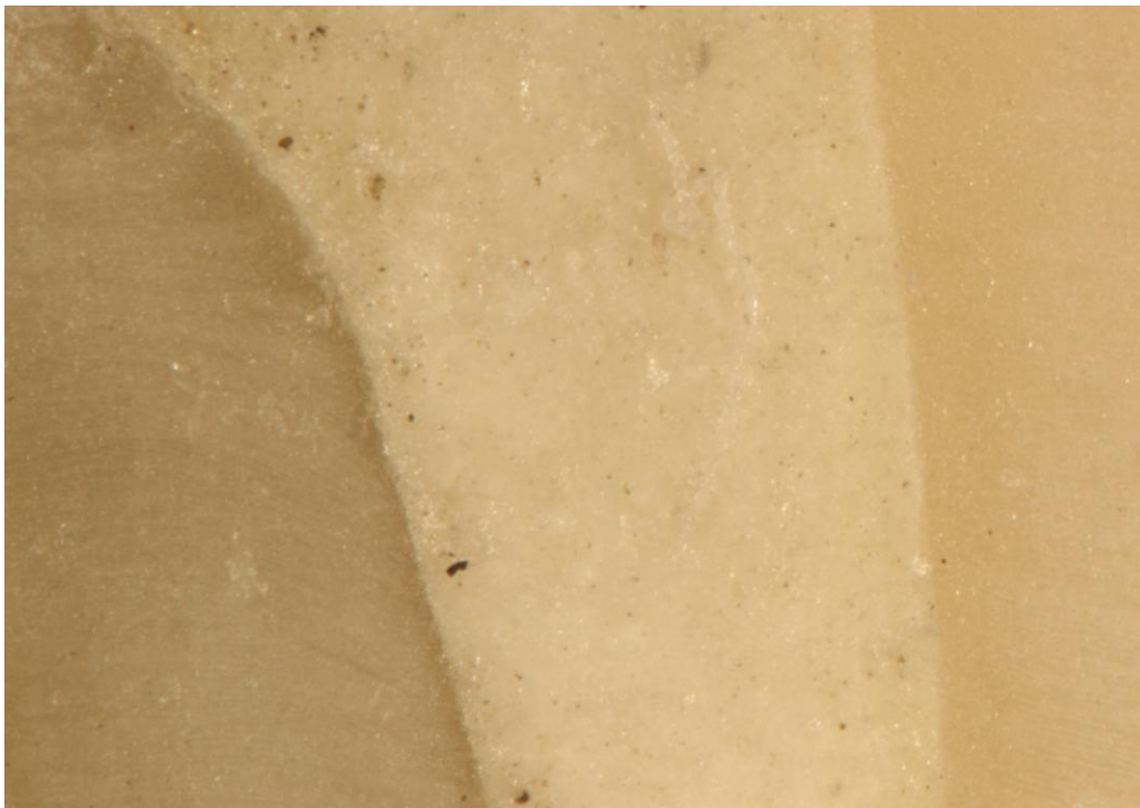
Figura 1 – Imagem do agregado de trióxido mineral branco após a reação de presa, com uma ampliação de 6 vezes e recurso ao estereomicroscópio (Nikon® SMZ 1500, Tóquio, Japão), com sistema de reforço de luz por fibra ótica (Intralix® 5000 – I, Volpi, Suíça).
