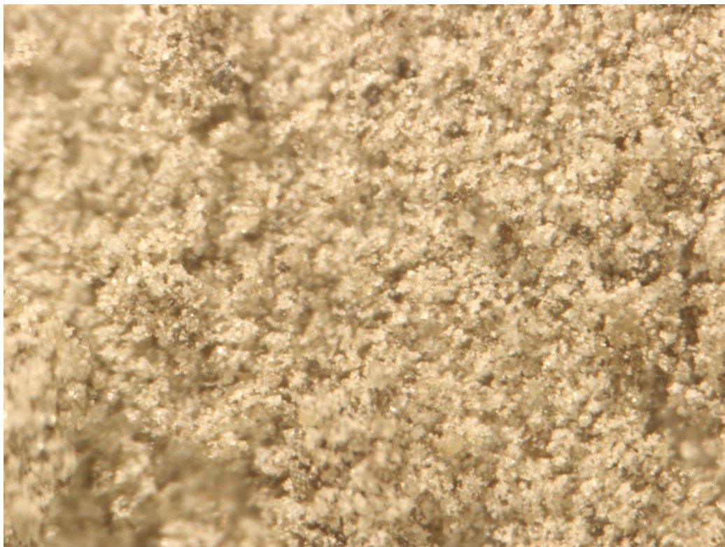
Figura 10 – Partículas de várias dimensões (predominância de 10 \mu m) do cimento de Portland experimental após separação por ultrassons, com uma ampliação de 6 vezes e recurso ao estereomicroscópio com sistema de reforço de luz por fibra ótica.
