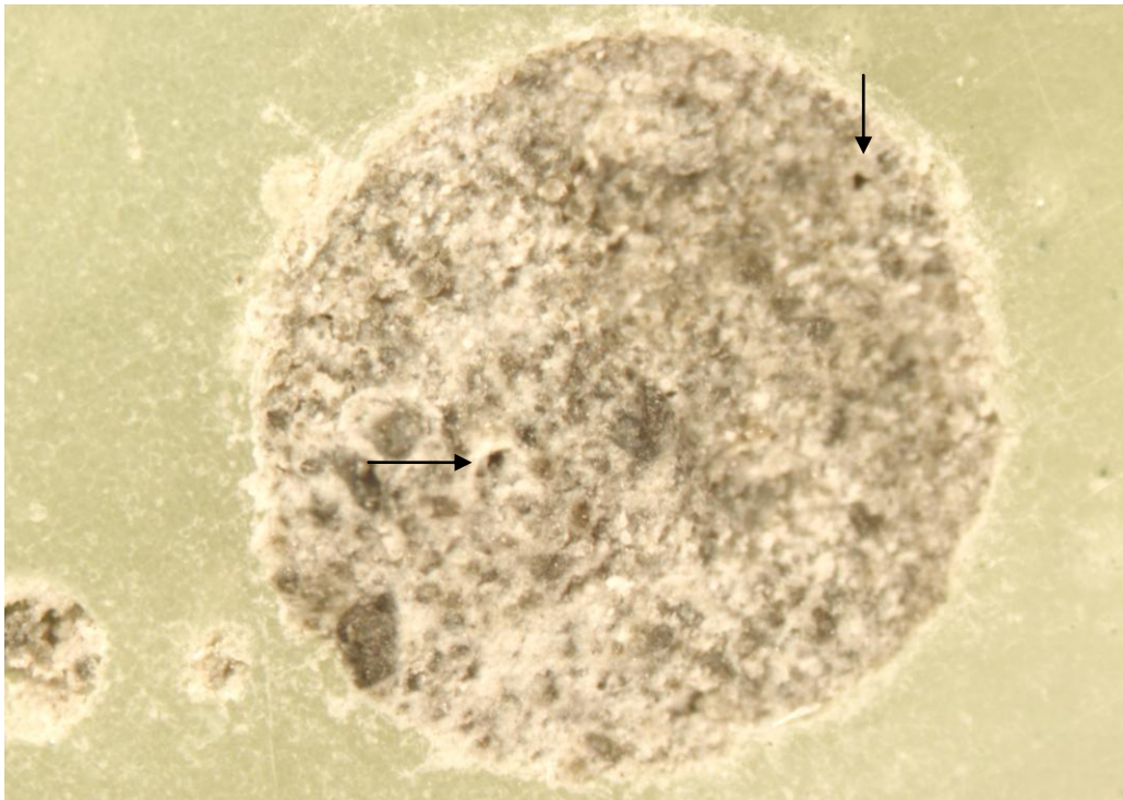
Figura 11 – Imagem de poros na superfície do cimento de Portland experimental numa cavidade de 2 mm de diâmetro, através do estereomicroscópio com sistema de reforço de luz por fibra ótica.
