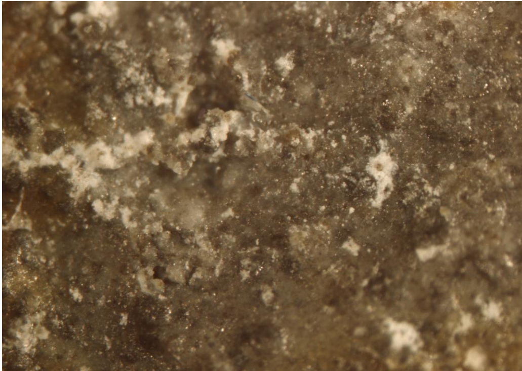
Figura 2 – Imagem do cimento de Portland experimental após a reação de presa, com uma ampliação de 6 vezes e recurso ao estereomicroscópio com sistema de reforço de luz por fibra ótica.
