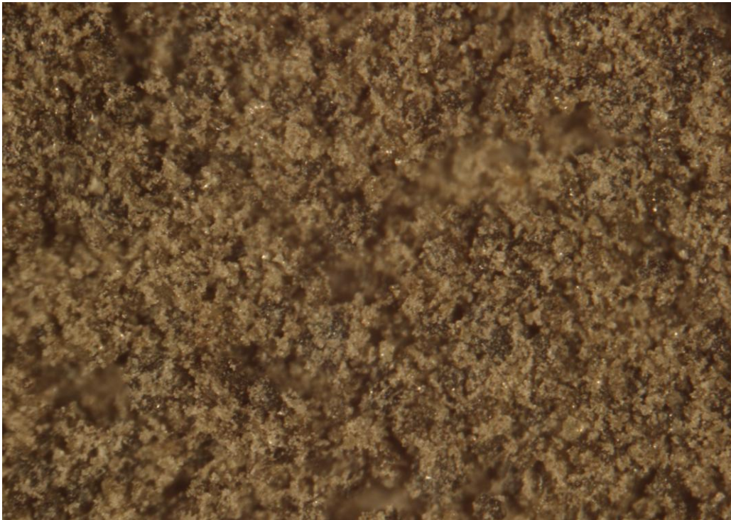
Figura 6 – Imagem do pó do cimento de Portland experimental, com uma ampliação de 6 vezes e recurso ao estereomicroscópio com sistema de reforço de luz por fibra ótica.
