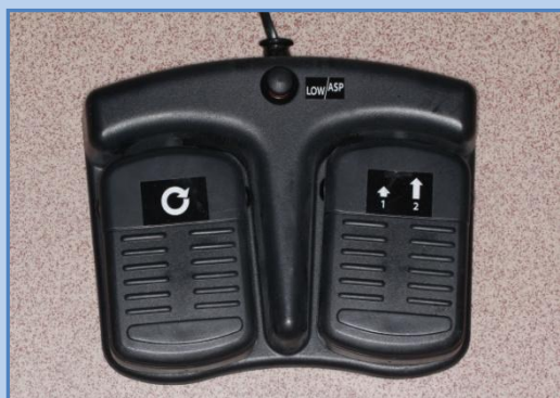
Figura 2 – Pedais do aparelho QuickSleeper®. O pedal esquerdo controla a rotação da agulha de modo a perfurar o osso. O pedal direito controla a quantidade de anestésico administrado no osso esponjoso.
