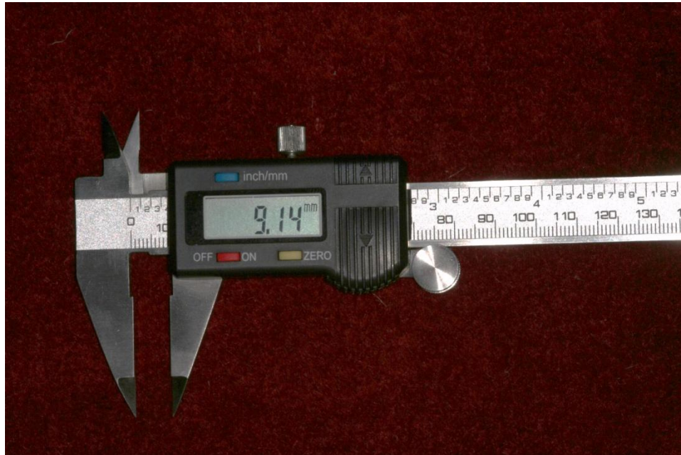
FIGURA 1 - Calibrador com escala Vernier com uma precisão de 0,01mm.
