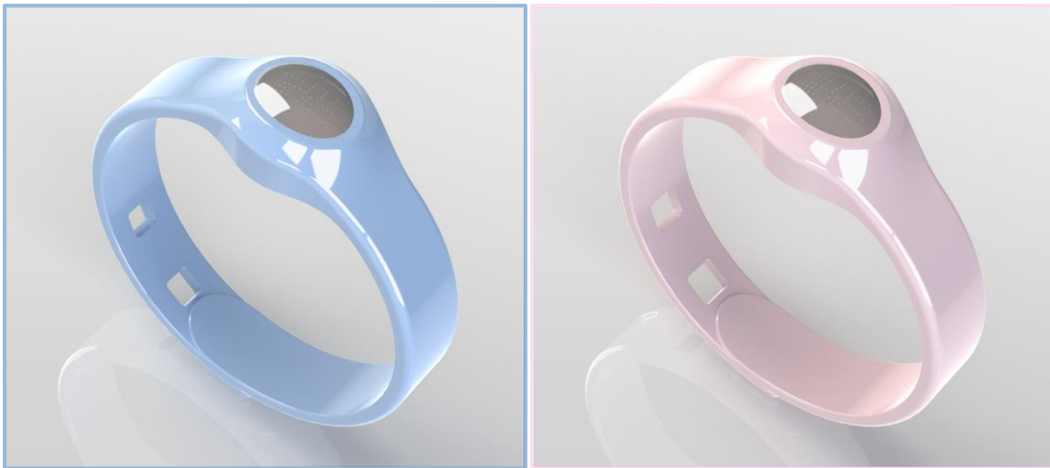
Figura 15 – Design do protótipo final da pulseira para monitorização da temperatura corporal de um bebé.
