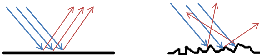
Figura 11. Representação esquemática dos dois tipos de reflexão. a) Reflexão especular; b) reflexão difusa.
