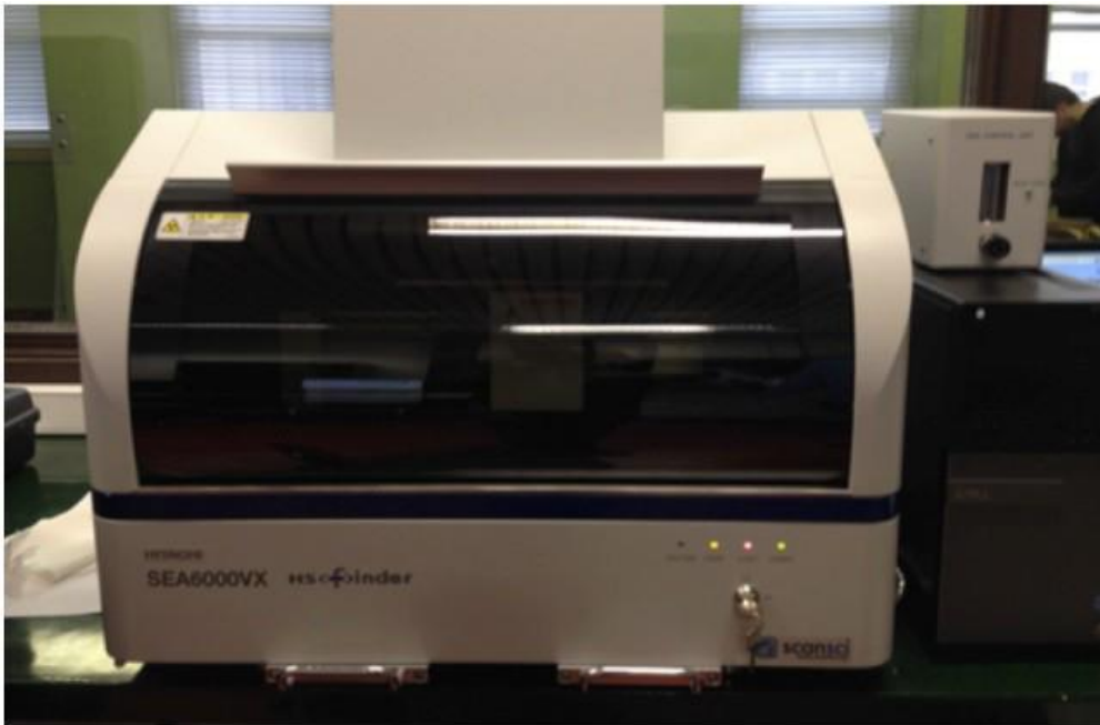
Figura 4.4: Equipamento de análise por fluorescência de raios-X (Hitachi modelo SEA 6000VX) Fonte: imagem fotografada pelo autor.
