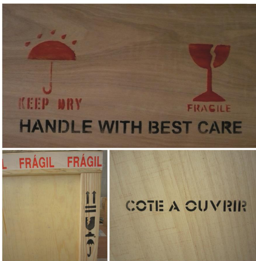
Símbolos de precaução, marcas de direção e indicações de abertura de caixas
