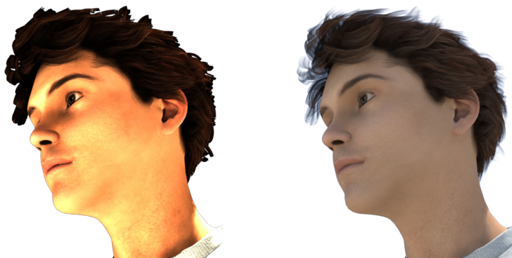
Fig.55 e 56 Personagem com material miss_skin_shader (esquerda) e Lambert ( direita)
