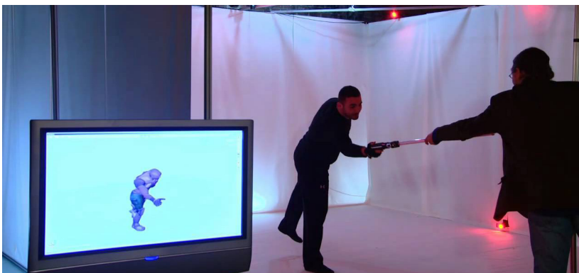
Fig.16 Estúdio produzido pela OrganicMotion para a gravação de motion capture sem marcadores
