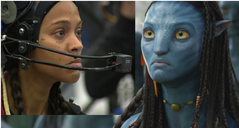
Fig.21 Uso do “head rig” para a captura das expressões faciais da atriz Zoe Saldana em “Avatar”
