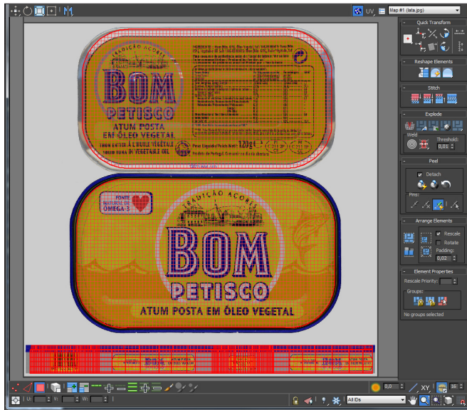
Fig. 81 e 82 - Exemplo de aplicação de UVW Mapping a um objecto (lata de atum) e textura criada num editor de imagem.
