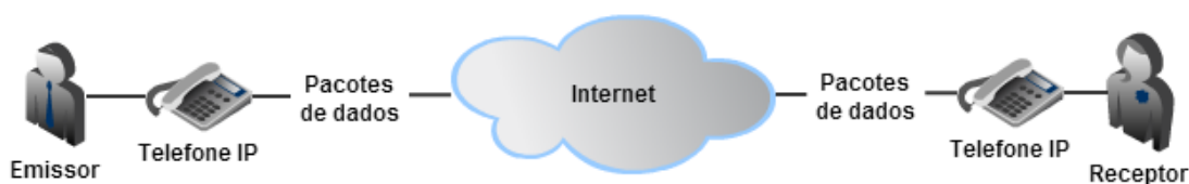
Figura 1 – exemplo de comunicação entre dois intervenientes através de um sistema de comunicações VoIP [1]
