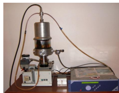
Figura 6: Sistema de pulverização catódica de ouro EDWARDS e fonte de potência HUTTINGER
