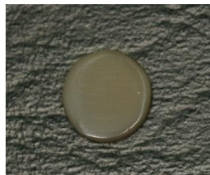
Figura 1: Disco de cerâmica após polimento com o sistema Exakt
