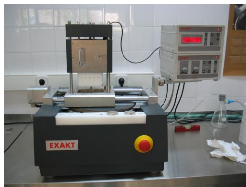
Figura 2: Unidade de polimento do sistema Exakt.
