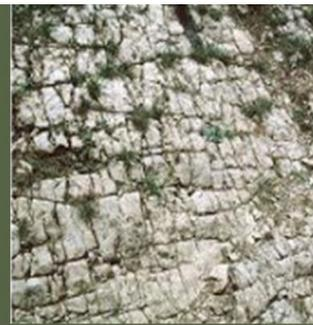
**Figura 20 – Fraturação/desgaste das Rochas**
