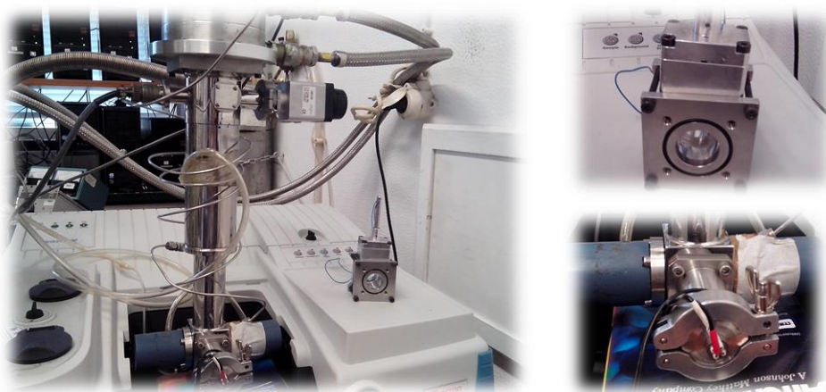
Figura 2.2 Forno para amostras sólidas com reduzida pressão de vapor (à esquerda, conectado ao criostato) e válvula de gaveta (à direita).
