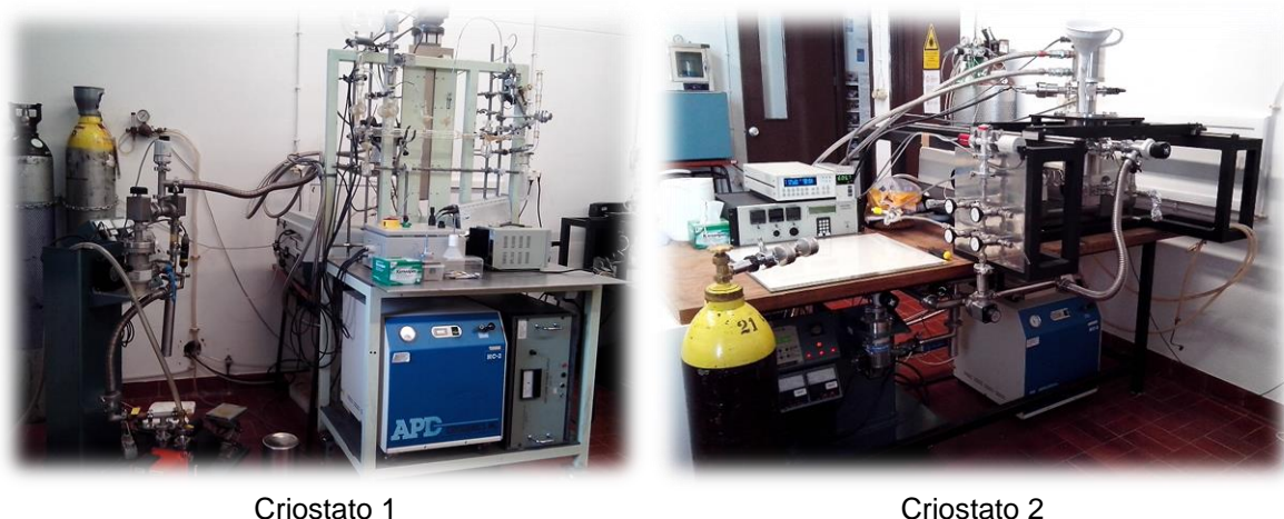
Figura 2.3 Sistemas experimentais de espectroscopia de infravermelho com isolamento em matriz do LMCB do Departamento de Química da Universidade de Coimbra.
