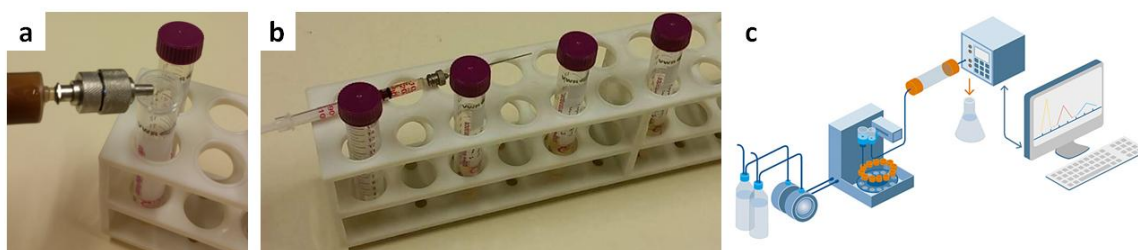
Figura 12: Tratamento das amostras para HPLC; a) ultrafiltração; b) amostras já basificadas para injeção e c) ilustração do funcionamento do HPLC com sua coluna de separação (Imagem: hiq.lindegas.com, 2008)
