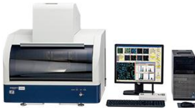
Figura 2.2 - Aparelho de bancada de fluorescência de raios-X utilizado- High Sensitivity Fluorescent X-ray Analyser (HSFinder) SEA6000VX da Hitachi High-Tech Science Corporation® (adaptado de [5])
