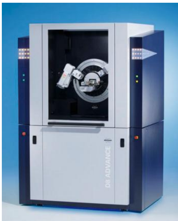
Figura 2.12 - Aparelho utilizado na técnica de difração em pó de raios-X - D8 Advance da Bruker® (adaptado de [16])
