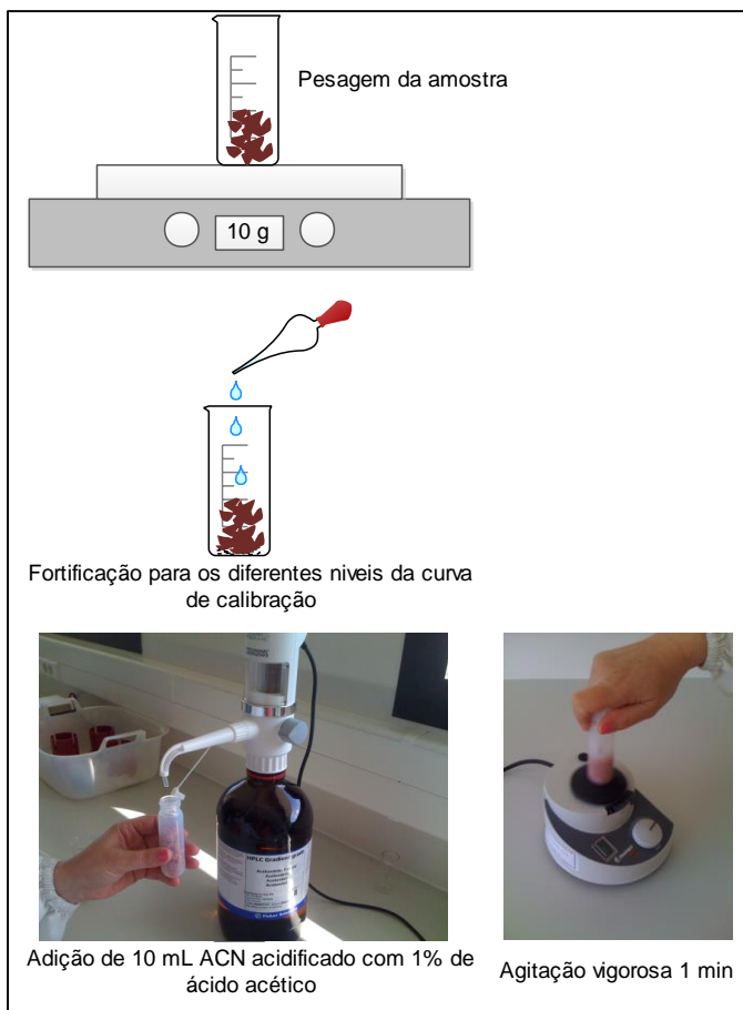
Fig. 3.5 Fase de extração, matriz com ACN acidificado (1% de \text{CH}_3\text{COOH} ).
