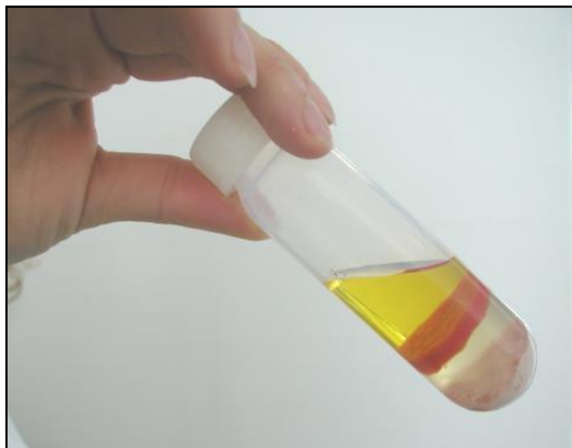
Fig. 2.6 Extrato da matriz obtido após extração com ACN acidificado com 1% de ácido acético, com adição da “mistura QuEChERS” e com posterior centrifugação.
