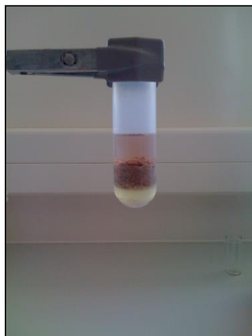
Fig. 3.7 Resultado após o procedimento de extração QuEChERS antes do “clean-up”.
