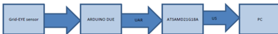
Figura 32: Diagrama de blocos de funcionamento do kit de avaliação do Grid-Eye como Arduino [34].
