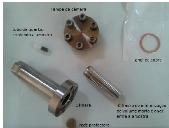
Figura 16- Câmara onde é inserida a amostra e respectivas peças.
