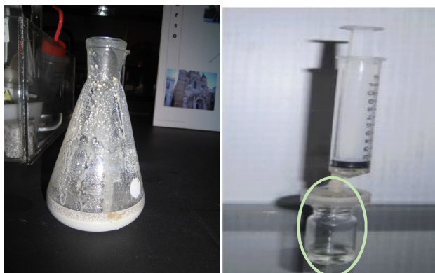
Figura 4.25 - Ilustração da filtração com o tratamento das águas oleosas e dióxido de titânio resultando numa limpidez a olho nu das águas oleosas iniciais.
