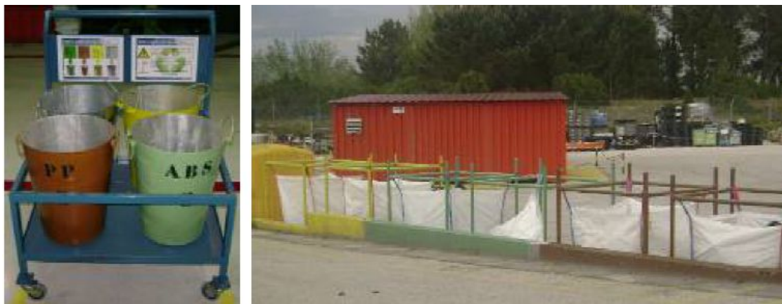
Figura 2.4 – Armazenamento dos resíduos de plásticos no interior das instalações e no parque de resíduos.
