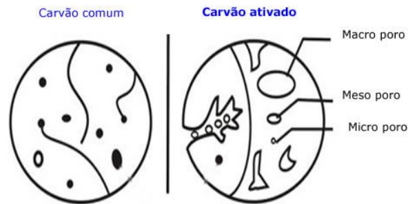
Figura 2.10 – Comparação entre o carvão comum e o carvão ativado, sendo que neste último é feita a distinção dos seus diferentes poros.
