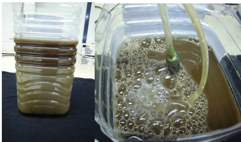
Figura 4.21 – Procedimento realizado na extração de águas oleosas evidenciando a criação de bolhas pequenas devido a uma boa difusão efetuada.
