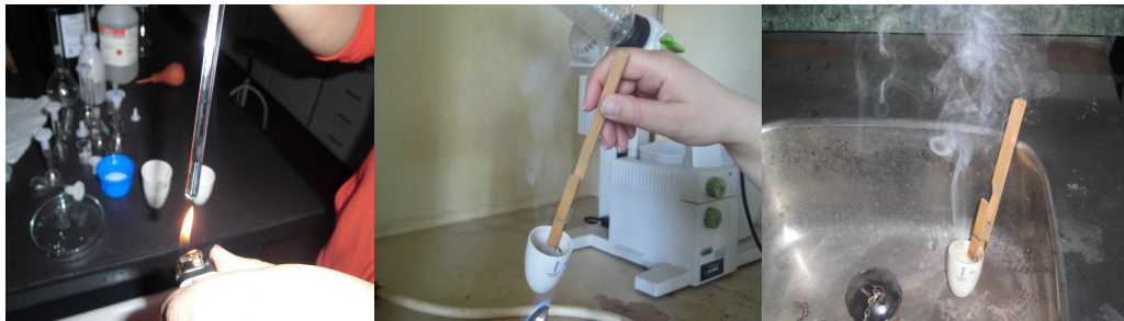
Figura 4.32 – Queima dos óleos puros e óleos das máquinas de injeção, originando um fumo branco, sem fuligem.
