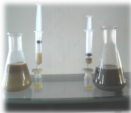
Figura 4.26 – Realização de duas formas de tratamento distintas, utilizando o dióxido de titânio (à esquerda) e o carvão ativado (à direita).
