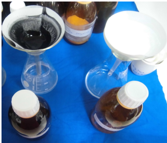
Figura 3.4 – Ilustração de duas das filtrações efetuadas para análise UV/vis.
