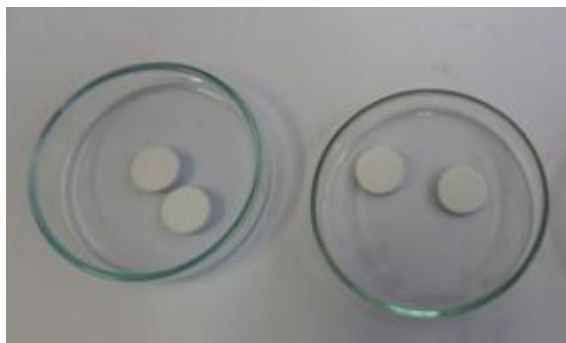
Figura 13 – Pastilhas de nanopartículas de zircónia preparadas para o teste de envelhecimento acelerado.
