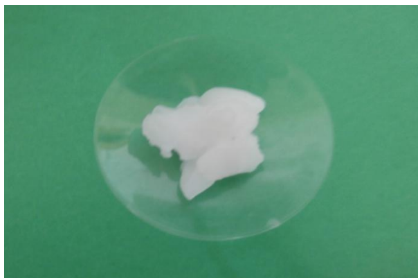
Figura 15 – Nanopartículas de zircónia sintetizadas por sol-gel, após a centrifugação.
