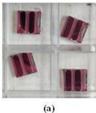
Figura 49: Células solares orgânicas construídas com uma razão de 1:2 de centro activo e PCBM, com  $16 \text{ mm}^2$  de área activa. (a) centro activo Bodipy-C12Br.
