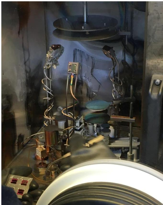
Figura 52: Deposição térmica de alumínio sob vácuo nos slides.
