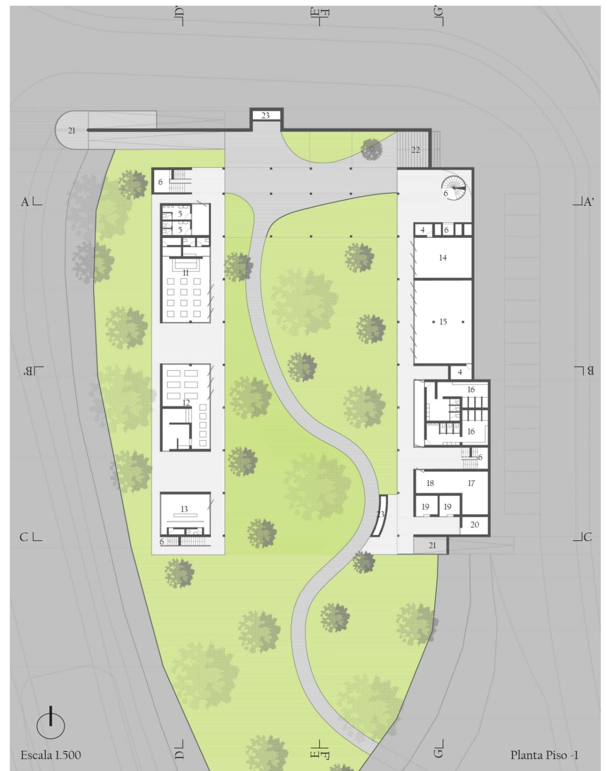
4 Arrumos; 5 Instalações Sanitárias; 6 Acessos verticais; 11 Bar; 12 Refeitório; 13 Loja; 14 Sala de Orações; 15 Sala Multiusos; 16 Blaneários; 17 Lavandaria; 18 Arrumos para bicicletas; 19 Boxes / Cavalariças; 20 Apoio de cavaliças; 21 Rampa de Acesso; 22 Escadas exteriores; 23 Bebedouro
