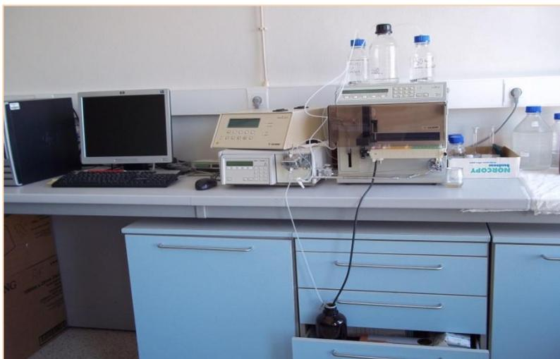
**Figura 12.** Sistema de HPLC utilizado neste estudo para a quantificação de monoaminas (Fotografia tirada no Laboratório de Farmacologia e Terapêutica Experimental da Faculdade de Medicina da Universidade de Coimbra).
